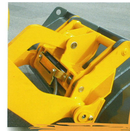
Bei PAUS Serie: hydraulische Schnellwechseinrichtung für viele Anbaugeräte
