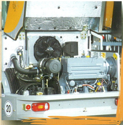
Außergewöhnlich gute Zugänglichkeit für Inspektions- und Wartungsarbeiten durch die weit aufstellbare GFK-Motorhaube
