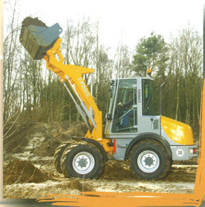
Z-Kinematik: Zwei Hubzylinder sorgen für hohe Hubkräfte im Schaufelbetrieb
